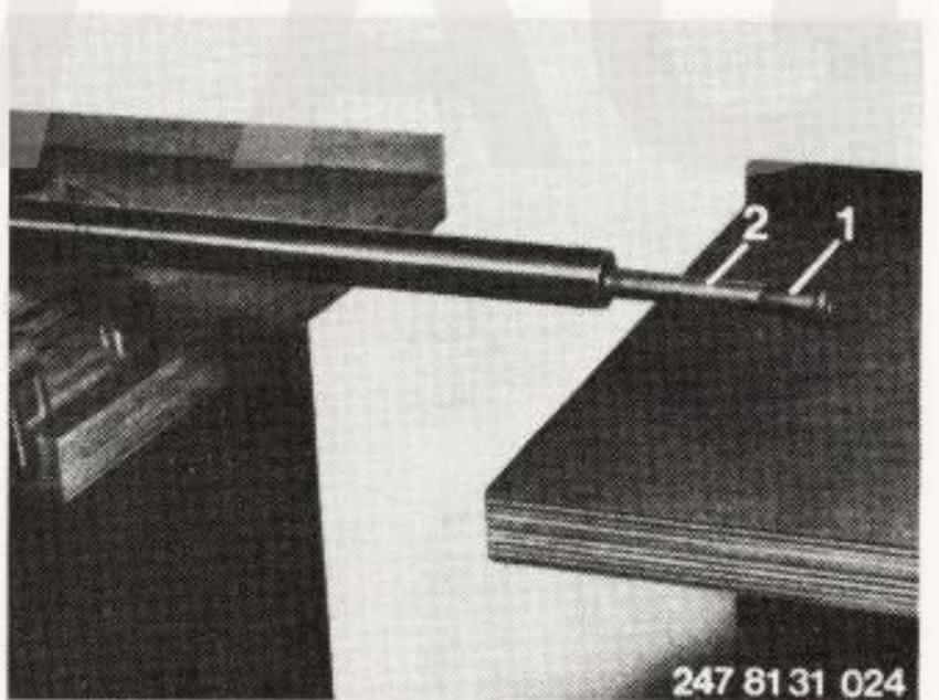
Sicherungsring mit Seegerringszange herausnehmen und kompletten Dämpfer aus Standrohr herausziehen.
