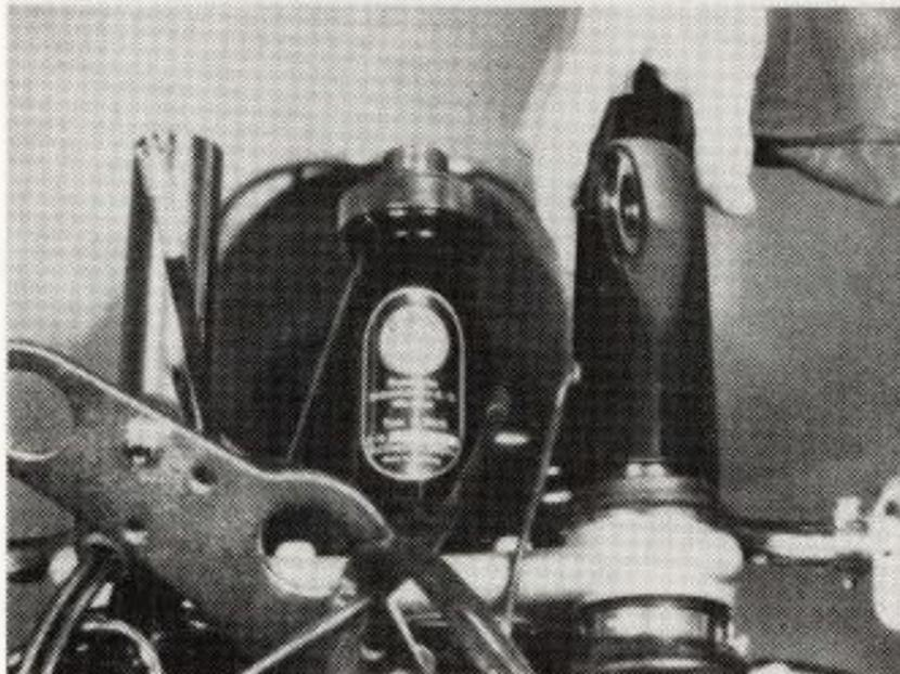
Scheinwerferhalter links und rechts mit Gummiringen und Kabel der Blinkleuchten abziehen (in den unteren Gummiringen befinden sich Bohrungen für Entlüftungsröhrchen in der Gabelbrücke und Bohrungen für Leitungen zu den Blinkleuchten).
