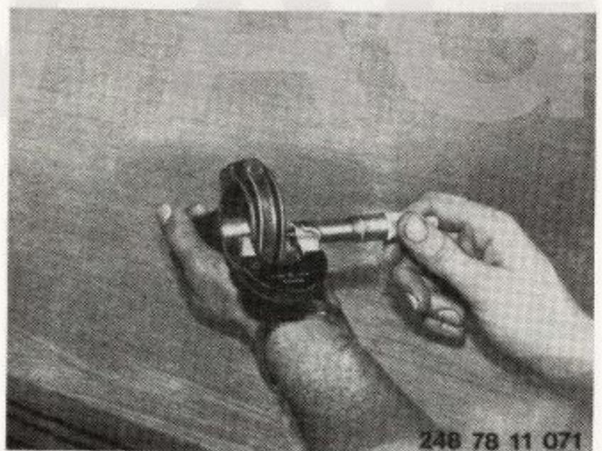
Ist die Verschleißgrenze des Innendurchmessers der Kolbenbolzenbuchse überschritten, Kolbenbolzenbuchse auspressen. Maße siehe Techn. Daten.
