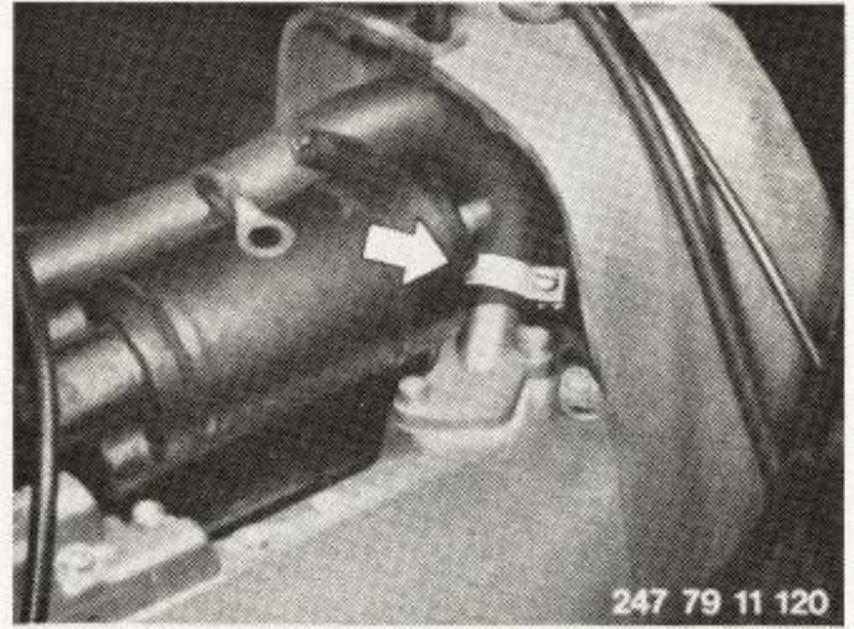
Entlüftungsschlauch am Luftfiltergehäuse links und rechts herausziehen.
