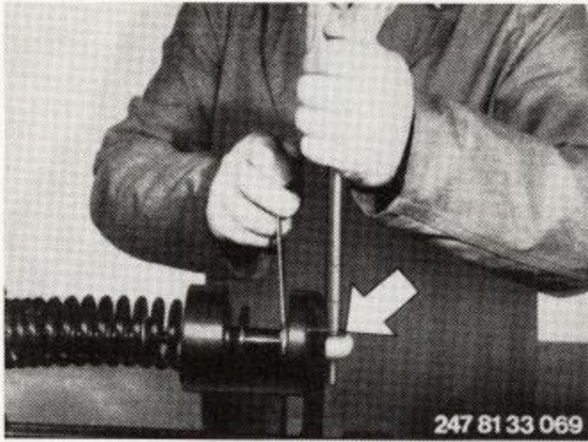
Druckstück an der Spannklaue zur Anlage bringen und Federbein so weit vorspannen, bis sich der Gabelschlüssel an der Schlüssel­fläche der Kolben­stange des Dämpfers ansetzen läßt. Gummipuffer vorher zu­rückschieben. Federbeinauge mit geeignetem Dorn von der Kolben­stange lösen (Pfeil).
