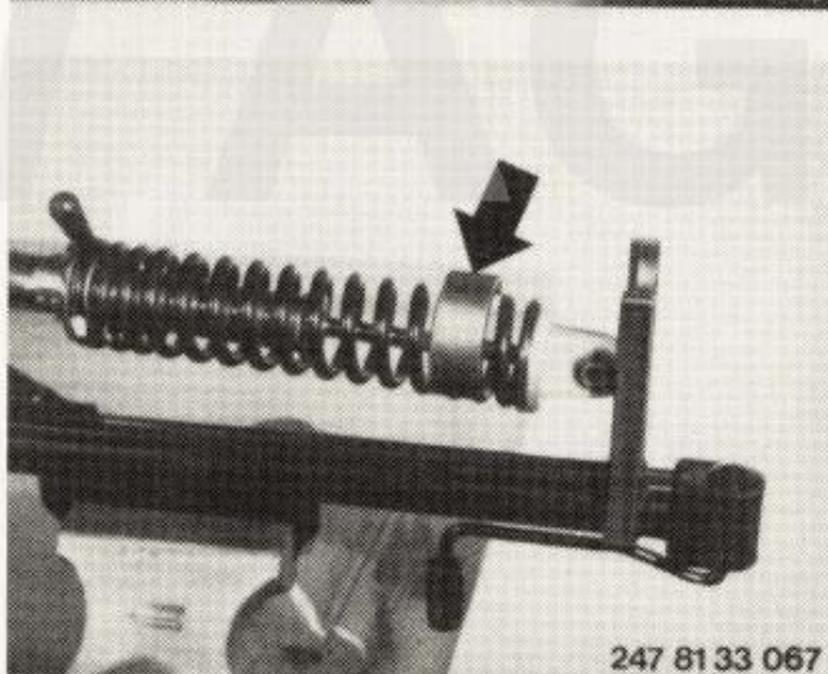
Druckstück BMW-Nr. 33 5 610 bis Anlage Klemmstück auf das Federbein aufschieben. Der Bund (Pfeil) muß auf der Seite der Spannklaue (1) sein.
