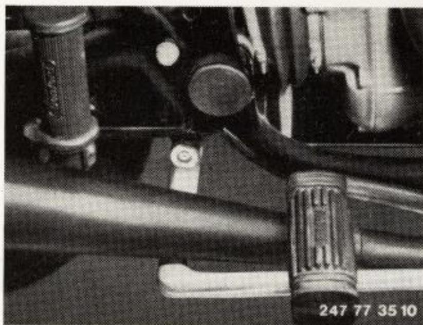
Sicherungsbolzen von der Brems-Zugstange lösen und Zugstange abnehmen.
