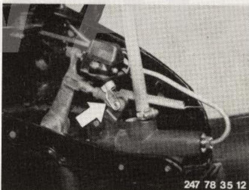
Bei leichtem Fingerdruck auf den Fußbremshebel ist ein Leerweg bis zum Druckpunkt des Hauptbremszylinders spürbar.
